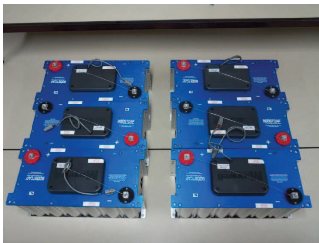
Fig. 5.5 Módulos BM0D0165-E048 de Maxwell Technologies.
